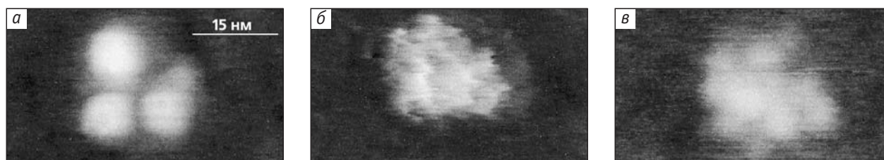
Рис.5. Разрушение молекулы IGG, сидящей на слюде, в ходе АСМ-эксперимента (прерывисто-контактный режим) [2]: первое изображение (а); изображение при втором сканировании на более низкой высоте (б); третье сканирование показывает уже полностью разрушенную молекулу (в).
